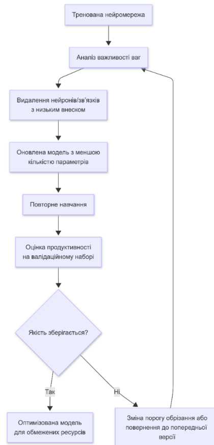
Рис. 4. Алгоритм зменшення моделі за допомогою аналізу вагів, редукції архітектури та повторного навчання
